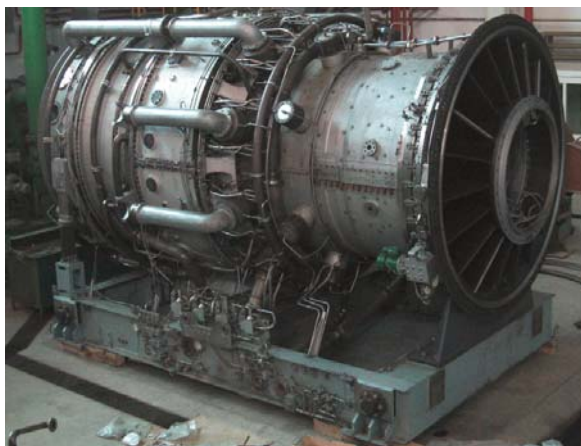
Фото 1. Общий вид корпуса, подвески и рамы ГТД-110 со стороны компрессора
